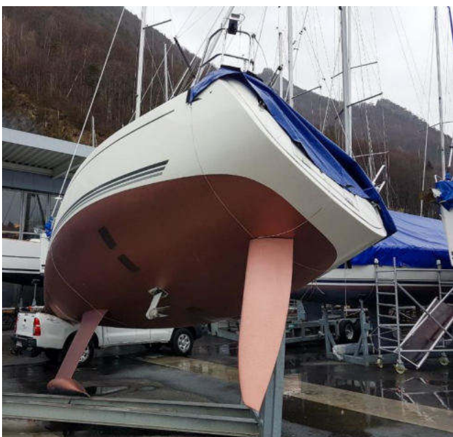
Diese Yacht wurde von einer extremen Windböe vom Lagerbock gerissen.
